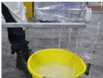
Floculant avant déversement sur le sol
